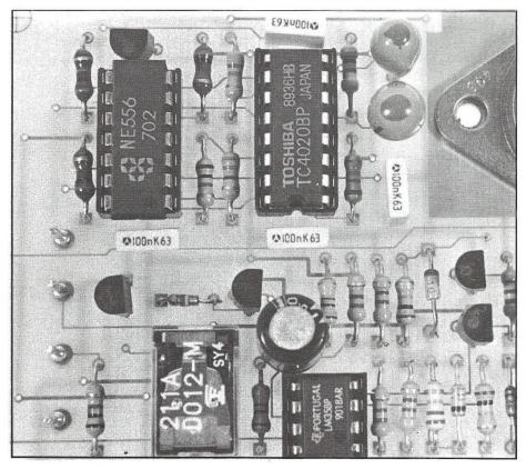
cuando se cuelgue el fax, en la patilla 1 tendremos 12 voltios, con los cuales activamos RL1 por mediación de T5 y permitimos que los impulsos puedan llegar al tener en la base del transistor T2 "0V".
